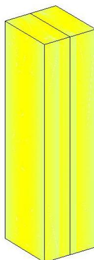
Okvirnice stola se izrađuju od masivnog drva javorovine. S nogama stola spajaju se spojem zaobljenog čepa i rupe. Ploča stola se na postolje pričvršćuje veznim elementima i vijcima 4x35 mm.
